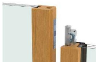
**NOVITÀ:** Il sistema di chiusura a scomparsa in acciaio è ora disponibile per tutti gli schemi di apertura. In questo modo, si ha una visione perfetta e pulita del profilo: i ganci di chiusura scompaiono quando la porta è aperta e sporgono solamente quando l'anta è chiusa premendo contro il telaio. In questo modo si riduce anche il rischio di lesioni dovute a parti sporgenti quando si attraversa la porta.
